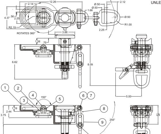
T12000D-1G0A TIEDOWN COMBO ASSEMBLY W/ SOLID SWIVEL (AS SHOWN) - WEIGHT: 22.82 LB.
