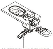
5. SQUEEZE THE LOCK LEVER ON THE HANDLE TO RELEASE THE STAR SHAPED SPINNER NUT.
